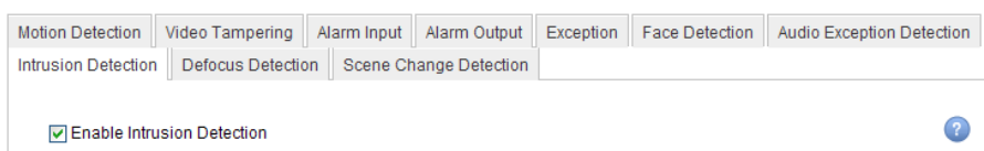
Рисунок 6-13 Настройка обнаружения вторжения на IP-камере
