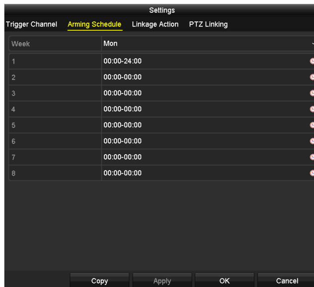
Рисунок 8-7 Установка расписания постановки на охрану тревожного входа
